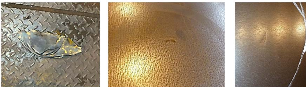
Рис. 2. Последствия отрыва части полосы в чистой группе клетей
